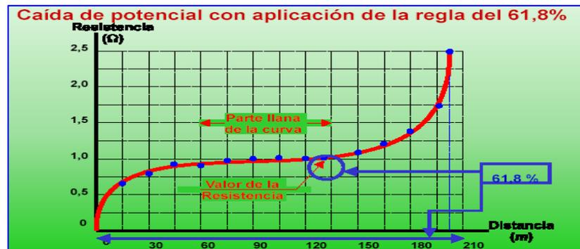
**Fig. 4. Método de la Caída de Potencial**
